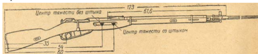
Рис. 1. Армейская служебная винтовка образца 1891/30 гг., кал. 7,62 мм (размеры в см)
