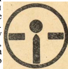
Рис. 312. Схема прицеливания при оптическом прицеле
